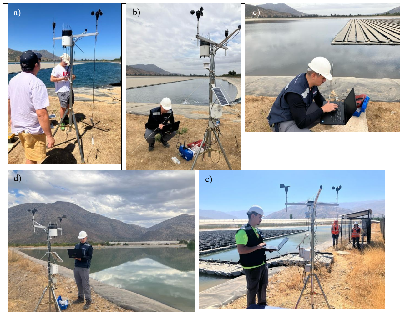
Figura 2: (a) y (b) Proceso de instalación y (c), (d) y (e) extracción de datos
